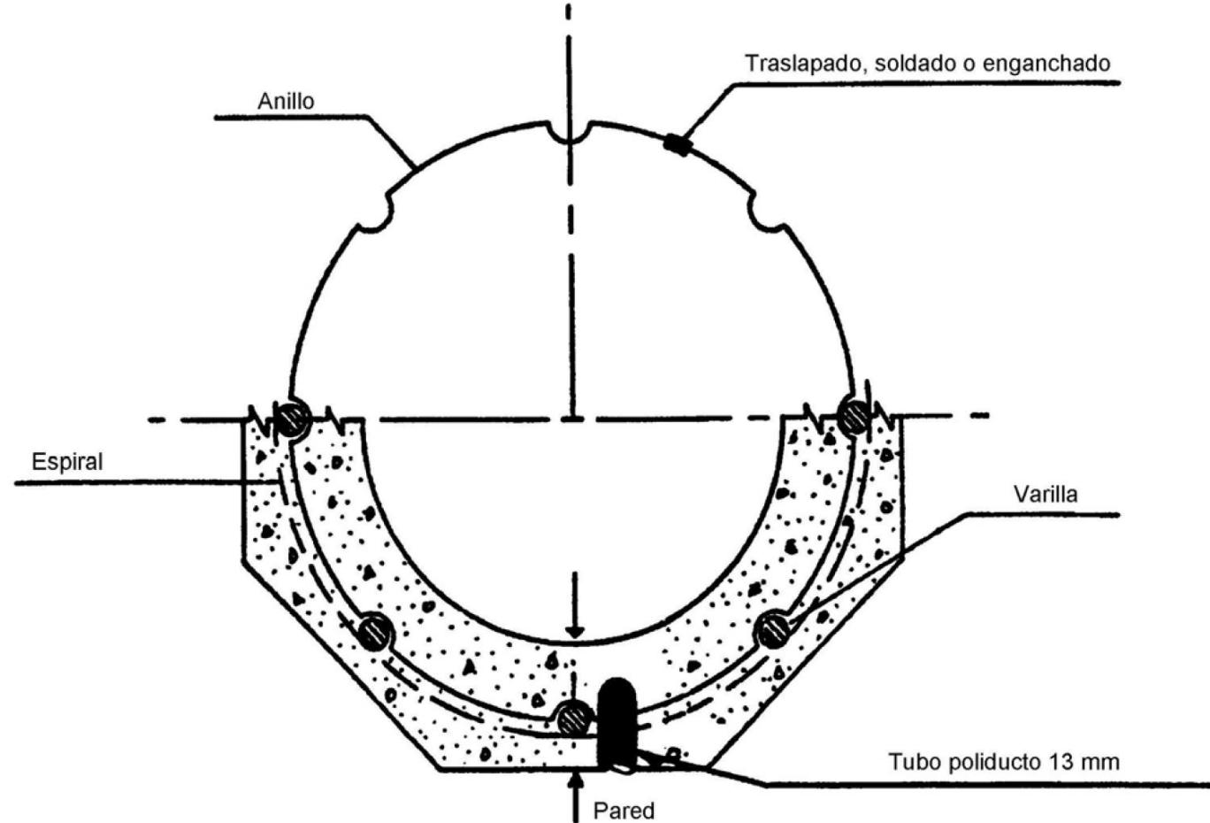
En poste tipo PCR para ambiente normal, la distancia del armado a la superficie exterior, debe ser de 15 mm a 20 mm, con pared de 52 mm y en los tipos PCR-C para ambiente de contaminación marino, la distancia del armado a la superficie exterior, debe ser de 25 mm a 30 mm, con pared de 62 mm.
