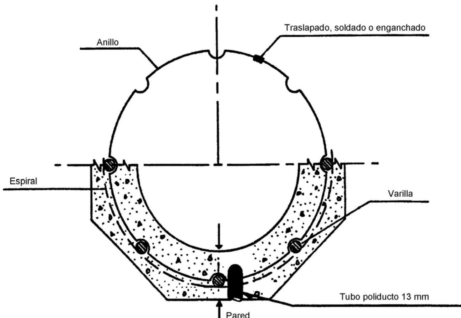
En poste tipo PCR para ambiente normal, la distancia del armado a la superficie exterior, debe ser de 15 mm a 20 mm, con pared de 52 mm y en los tipos PCR-\*C para ambiente de contaminación marino, la distancia del armado a la superficie exterior, debe ser de 25 mm a 30 mm, con pared de 62 mm.
